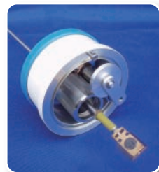
スタブおよびシャトルが 取付けられたトランスファードバイス
