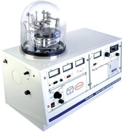
E6700 は拡張性を持ったコンパクトなベンチトップタイプのエバポレーターです。TEM/SEM のサンプル対応はもちろん、ユーザーの要求に合わせたオプションユニットを選択していただく事により幅広いニーズに対応できるように設計されています。
