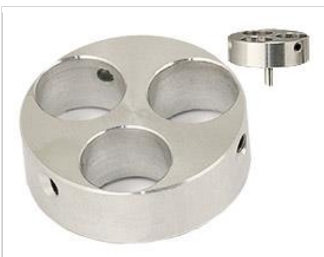
EM-Tec J3 マルチスタブホルダー—12.2 mm \varnothing スタブ 3 個用 31.5 \Phi x10mm ピン
