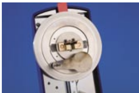
【Fig 2. カーボンエバポレーター】
